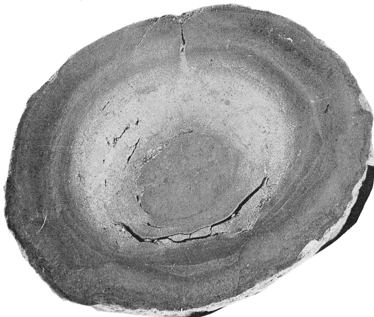
Fig. 2. — Coupe transversale d'une concrétion de sidérose, montrant le corps et sa structure concentrique, le manteau argileux et le noyau.
