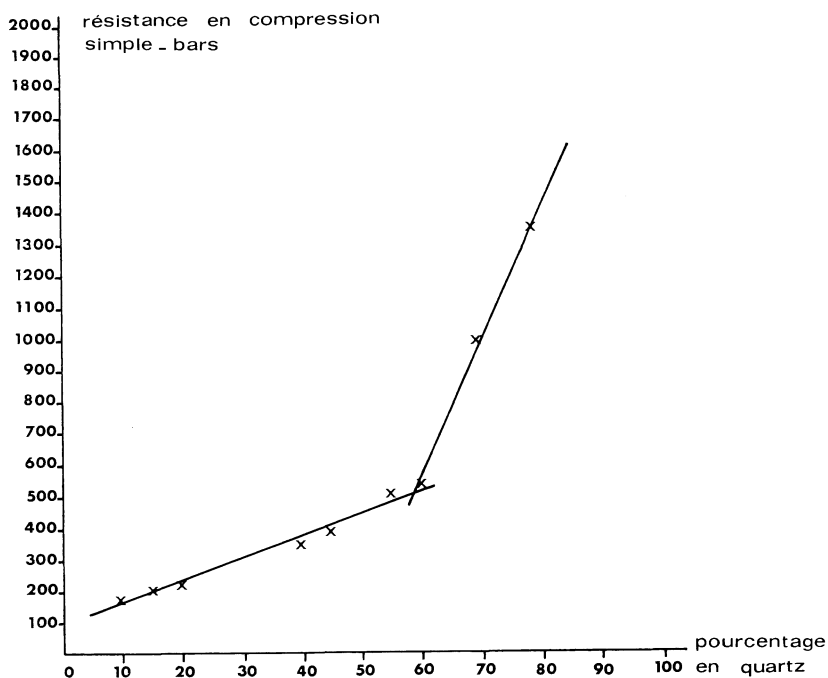
Fig. 1. — Influence de la composition minéralogique sur la résistance en compression simple. Roches du sous-sol de Liège, ensemble des essais sur échantillons secs. D'après Schroeder [2] et Polo-Chiapolini [3].
