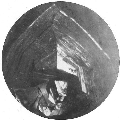
FIG. 4. Faces de dodécatétraèdre ( \times 23 ).
