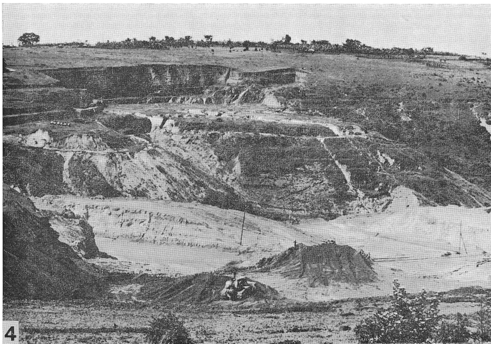
Photo 4 : Vue générale de la carrière de N'Tunga et des travaux dans la pegmatite stannifère albitisée (avril 1968). Cette photographie montre les niveaux des filons de quartz à muscovite et cassitérite, des filons de quartz avec grand cristaux de microcline totalement ou partiellement albitisés, avec muscovite, et cassitérite et des niveaux de pegmatites, albitisées avec cassitérite columbo-tantalite, béryl en petits prismes, spodumène et des petits nids de lépidolite. A noter que les têtes des filons de quartz avec grands cristaux de microcline avaient commencé à apparaître déjà au niveau du plancher de la carrière de N'Tunga. Le gros de ces filons avait été reconnu par travaux souterrains encore pendant la période 1944-1949.
