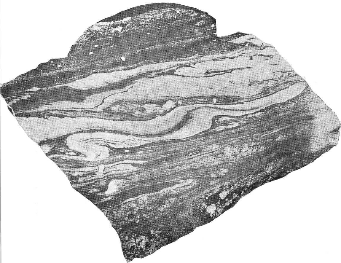
Fig. 3. — Dépôt rythmique de marcassite-pyrite (claire) et de blende (obscur), avec remarquable structure en « slumping ».
