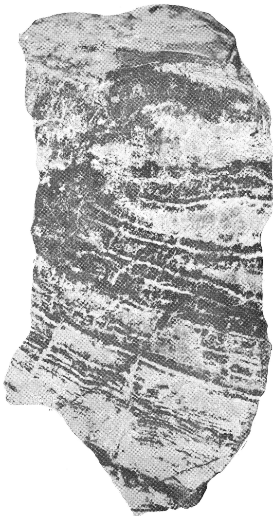
Fig. 6. — Échantillon de skarn dans le Sulcis.
