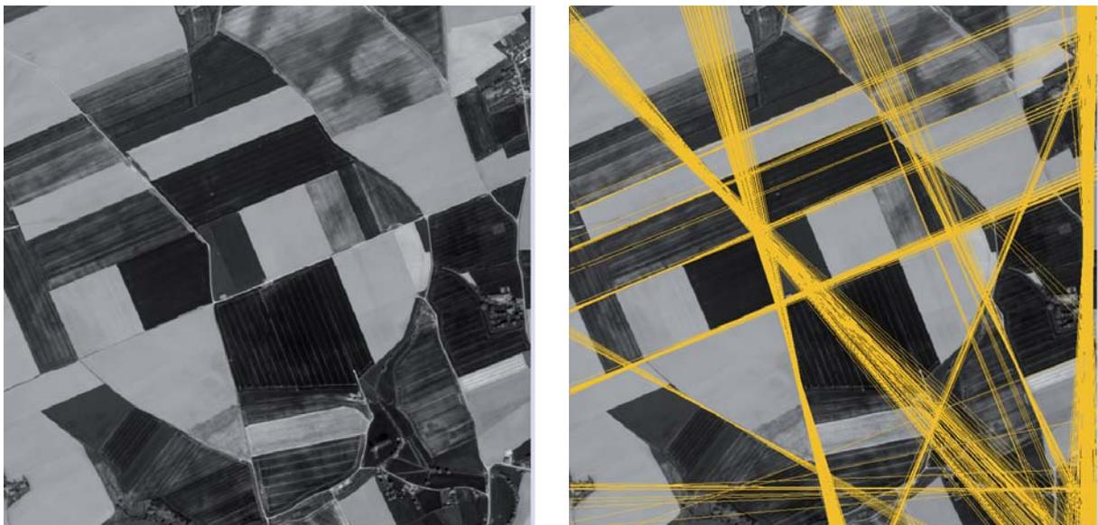
Figure 2. Résultat de la transformée appliquée à une image de Hesbaye au parcellaire bien structuré, terrain d'application idéal pour tester le programme de détection de structures linéaires.
