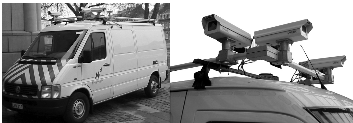
Figure 2. a) Véhicule équipé – b) Caméras frontales et latérales
