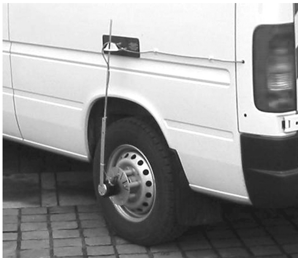
Figure 3. Odomètre fixé à la roue arrière du véhicule
