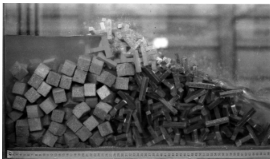
Figure 15. Modèle réduit du barrage en pierres lancées (ULg)
