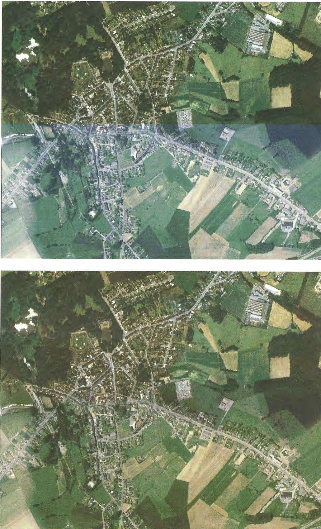
Figure 9. Mosaïques de deux extraits d'orthophotos A. En l'absence de correction radiométrique : mosaïque « brute ». B. Avec correction par calage d'histogrammes : mosaïque « corrigée ».
