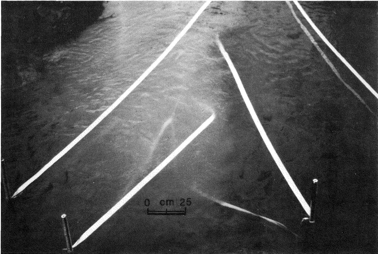
**Figure 12 :** Illustration du glissement et de la résurgence de l'écoulement du cours d'eau principal sous l'écoulement de l'affluent arrivant de la gauche. Les fanions montrent la complexité tri-dimensionnelle du mélange des écoulements dans le plan de cisaillement entre les flots des deux cours d'eau tributaires.
