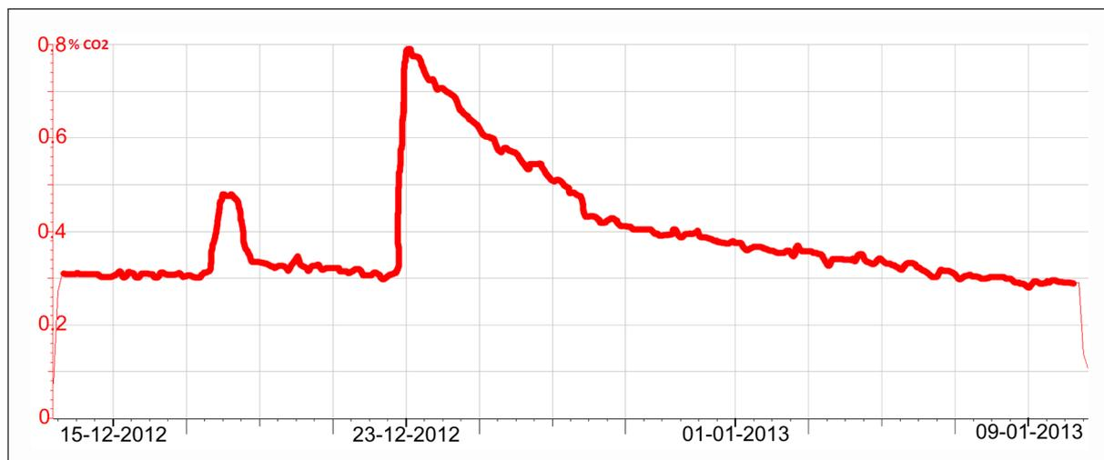
**Figure 24.** Hausse soudaine de la  $p\text{CO}_2$  à la sortie d'un petit puits impénétrable (le P2). En abscisse, le temps en jours. En ordonnée, la  $p\text{CO}_2$  en %.
