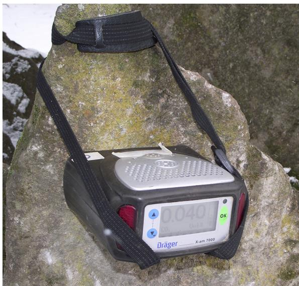
**Figure 5.** Le CO<sub>2</sub> mètre Draeger. La teneur en CO<sub>2</sub> de l'air analysé (jusque 6 %) se lit sur un moniteur à cristaux liquides.
