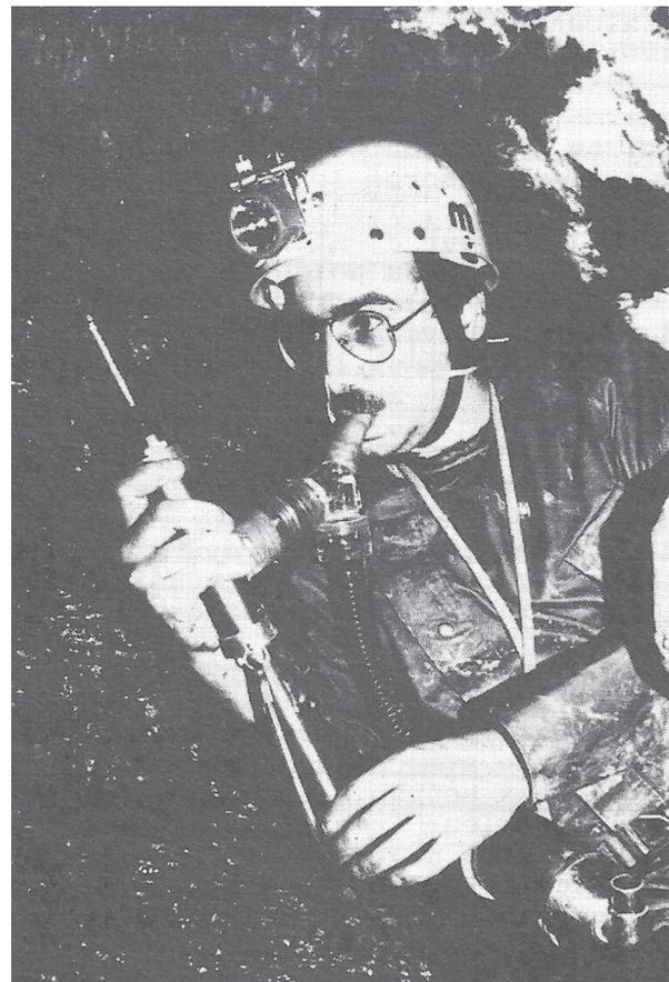
**Figure 31.** Dispositif pour empêcher l'arrivée d'air expiré par l'opérateur lors de mesures en milieu très confiné. L'opérateur aspire l'air de la grotte mais une soupape l'empêche de l'expirer vers l'extérieur ; une autre soupape, fonctionnant à l'expiration, envoie l'air expiré dans un réservoir à chaux sodée qui absorbe le  $\text{CO}_2$  anthropique. Pour obliger l'opérateur à respirer par la bouche, un pince-nez de natation lui bouche le nez.
