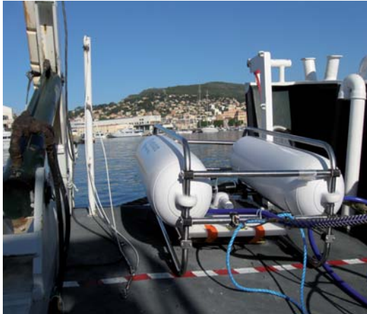
Figure 10. Equipement sismique boomer et mise en oeuvre.
