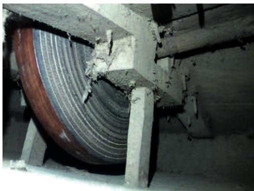
Illustration 3. Vue endoscopique de la roue, des barres de support et de l'axe de la manivelle (© MIM, Manu Frederickx).
