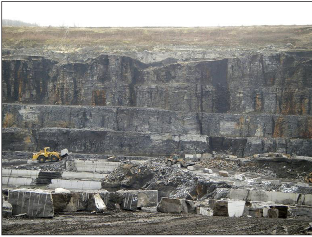
Figure 3. Fantômes de roche (Carrière du Clypot, Neufvilles). Cette carrière exploite la pierre bleue dans le Tournaisien terminal. A l'avant plan, les banquettes de découpe sont dans le faciès « petit granit » (Formation d'Ecaussinnes). La paroi à l'arrière plan est constituée des faciès « raches avec et sans cherts » (Formation de Thiarfont). Les fantômes de roche sont visibles sous la forme de surfaces plus sombres, principalement structurées ici comme des couloirs verticaux descendant du toit sous la couverture sablo-argileuse paléogène. Quelques formes de type fantôme sont totalement incluses dans la masse rocheuse.
