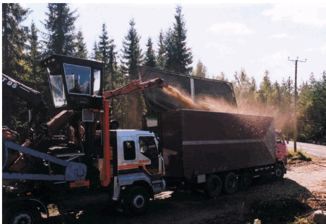
Figure 4. Filière rémanents forestiers : grosse déchiqueteuse — Forest residues supply chain: large chipper (Photo D. Marchal).
