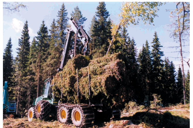
Figure 5. Filière rémanents forestiers : récolte des rémanents en balles pour broyage sur plate-forme bois et stockage — Forest residues supply chain: harvesting of residues in bales for chipping and storage on an industrial site (Photo D. Marchal).
