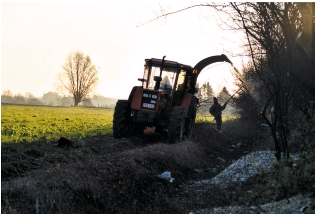
Figure 2. Filière rémanents forestiers : petite déchiqueteuse — Forest residues supply chain: small chipper (Photo D. Marchal).
