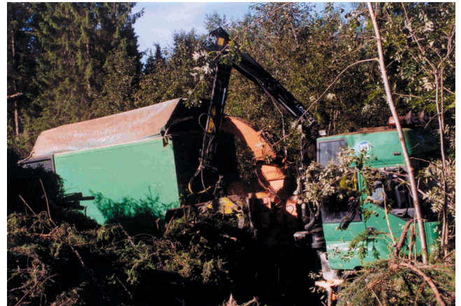
Figure 3. Filière rémanents forestiers : déchiqueteuse moyenne — Forest residues supply chain: medium chipper (Photo D. Marchal).
