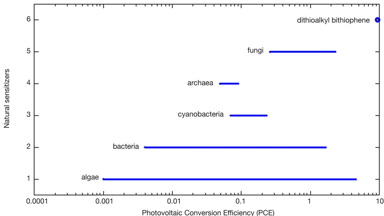
**Figure 3.** Solar photovoltaic conversion efficiency (PCE) ranges for different natural photosensitizers — *Plages d'efficacité de conversion solaire photovoltaïque (ECP) pour différents photosensibilisateurs naturels.*
