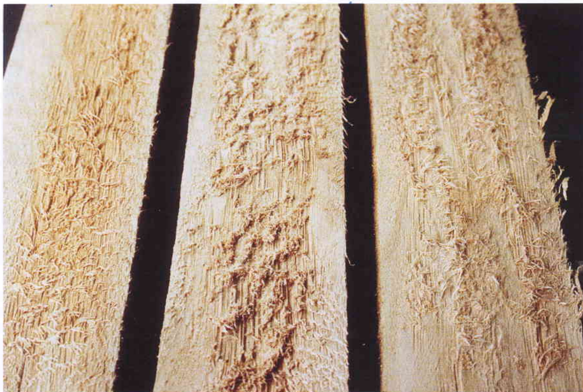
Photo 1. Lamelles de peuplier montrant un état de surface pelucheux suite à la présence de fibres gélatineuses en proportion importante dans le bois — Poplar planks showing woolly surface due to the presence of an important proportion of gelatinous fibers in the wood.
