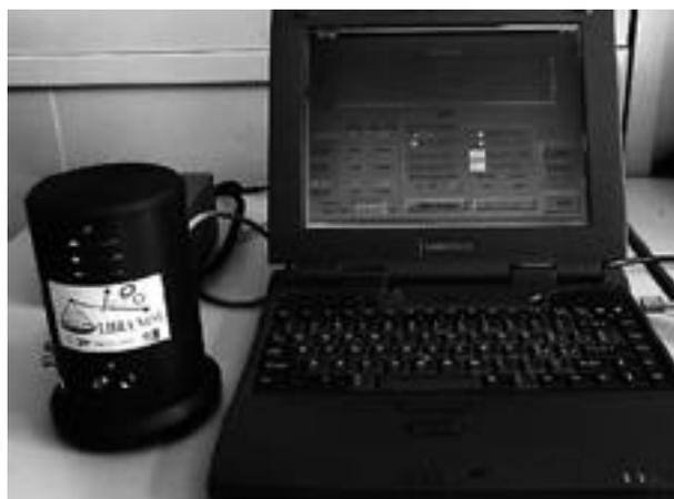
**Figure 2.** Picture of the currently available versions of LibraNose. The instrument is shown on the left side connected to a notebook computer — *Version actuellement disponible du LibraNose. L'instrument se situe à gauche de l'ordinateur portable.*
