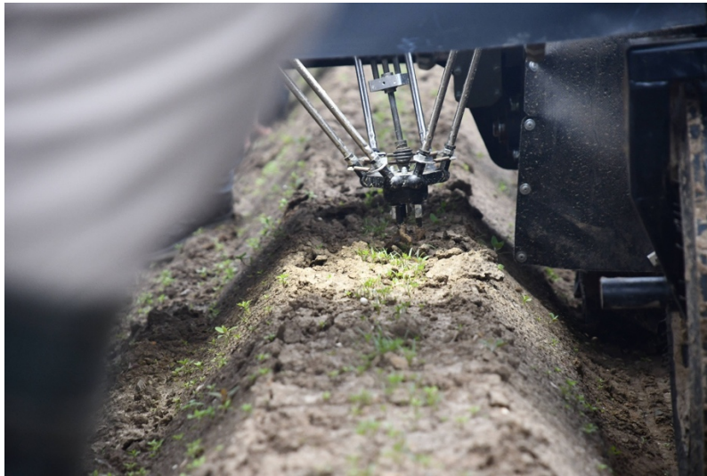
Figure 2. Mechanical grippers (detail from Maverick autonomous robot) – Pinces mécaniques (détail du robot autonome Maverick).
