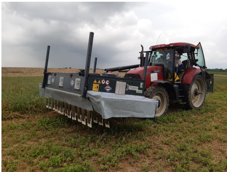
Figure 4. Electrical weeder – Désherbeur électrique .
