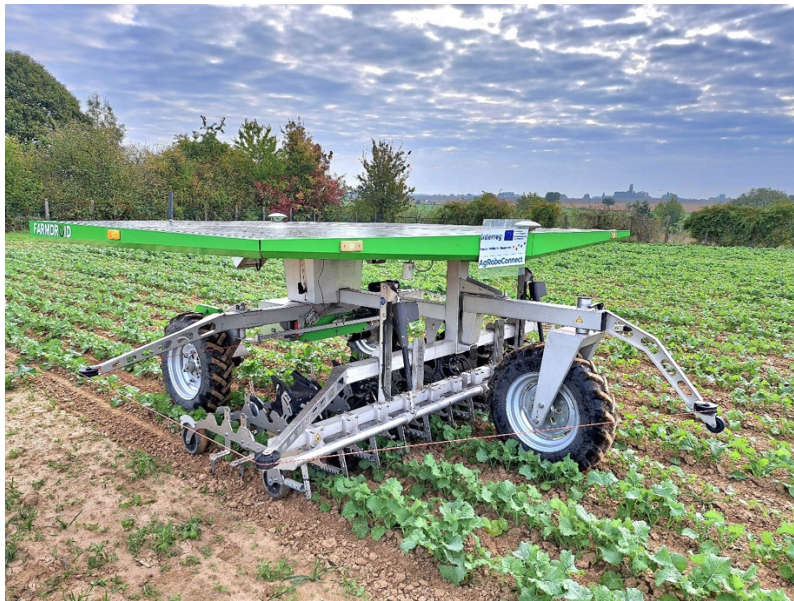
Figure 6. FD20, sowing and weeding robot using seed mapping for mechanical weeding within the row – FD 20, robot de semis et de désherbage utilisant la cartographie des graines pour désherber mécaniquement le rang.
