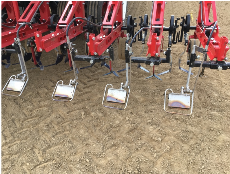
Figure 3. Direct flame weeder – Brûleur à flamme directe .
