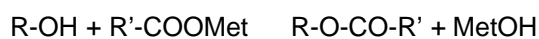
Figure 5. Équation générale de la réaction de transestérification — General equation of the transesterification reaction (Met = méthyl).
