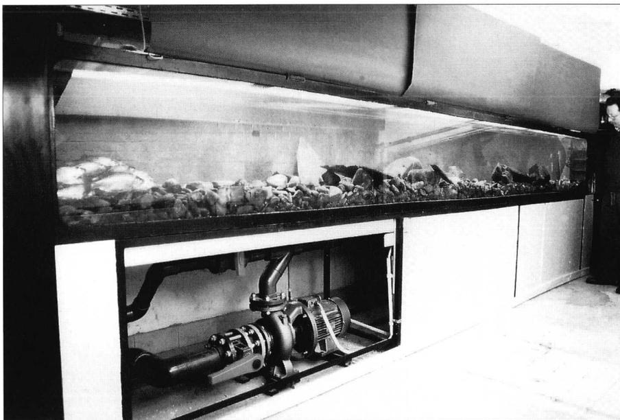
**Photo 3.** Vue partielle de la « rivière artificielle » ou *fluvarium* : aquarium de 5 m de long dans lequel circule un courant d'eau généré par une pompe de 100 m<sup>3</sup>/heure (photo M. BOCKIAU).
