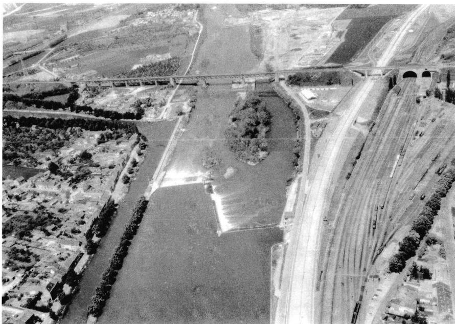
**Photo 138.** Vue aérienne de la Meuse en aval de Visé. De gauche à droite, au premier plan : le canal de jonction au canal Albert, la Meuse, l'autoroute Liège-Maastricht et la gare de triage ; au centre : le barrage déversoir, les îles Quaden et le pont-rails ; au-delà : les travaux du barrage de Lixhe ont commencé (fin des années 70).
