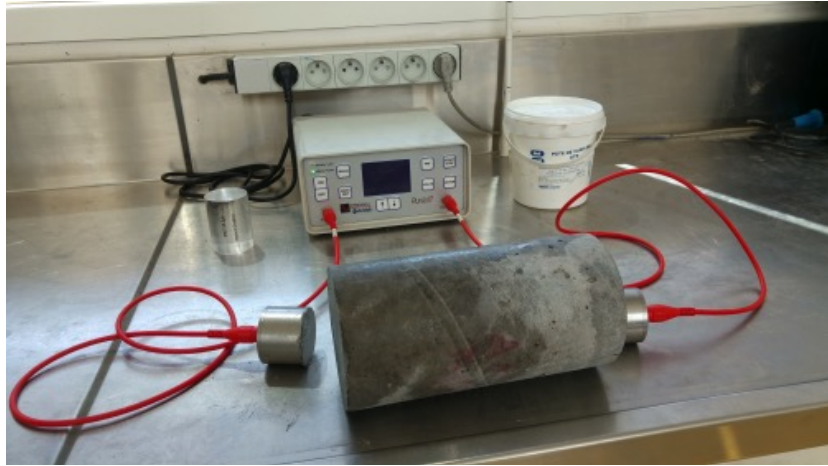
Figure 2. Dispositif de mesure des vitesses des ondes
