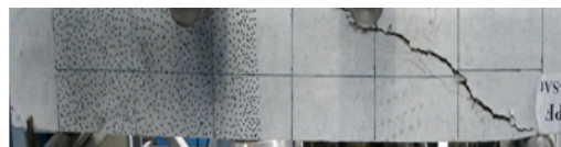
(a)- Rupture des poutres BHP-At
