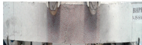
(h)- Rupture des poutres BHPF-3-35-SAt
