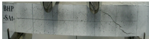
(b)- Rupture des poutres BHP-SAt
