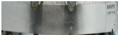
(g)- Rupture des poutres BHPF-2-60-SAt
