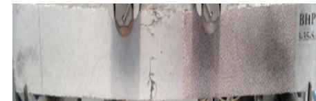
(f)- Rupture des poutres BHPF-2-35-SAt
