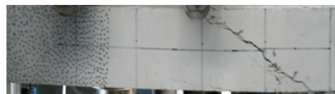
(b)- Rupture des poutres BHP-SAt
