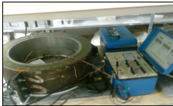
Figure 8. Essai de retrait empêché à l'anneau (LMDC, Toulouse)
