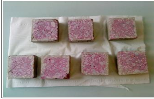
Figure 7. BAP fibrés, après 28 jours de conservation en cellule de carbonatation
