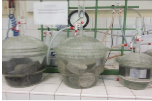
Figure 5. Mesure de la porosité accessible à l'eau
