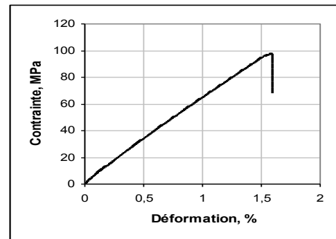
Figure 4. Essai de traction directe: courbe contrainte déformation de la fibre de diss
