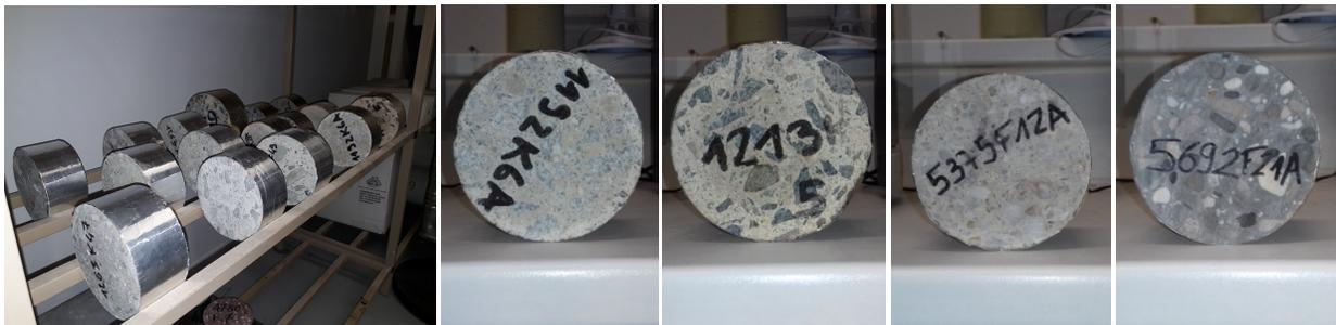
Figure 2. Photographies de rondelles de béton enrubannées.
