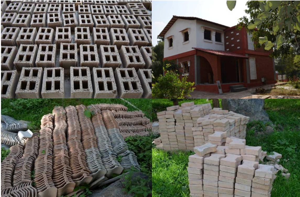
Figure 4. Applications utilisant le ciment LC<sup>3</sup> : briques, tuiles, pavés et maison d'habitation
