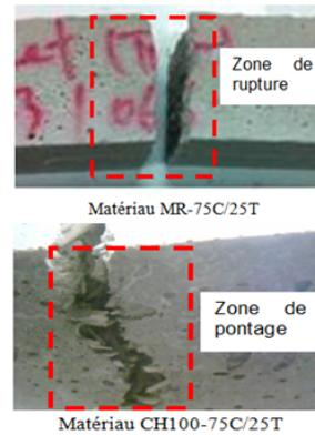
Figure 9. Etat des matériaux, après la rupture en flexion
