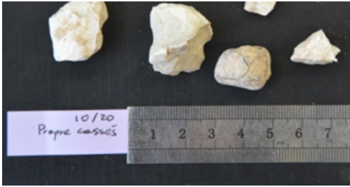
Figure 3. Granulats endommagés par TMC 600°C
