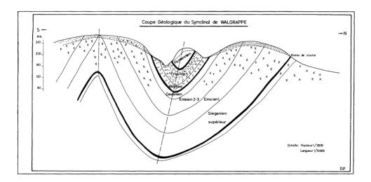
La structure présente un ennoyage Est de 15 à 20°. Dans la partie orientale. le pli est légèrement déversé vers le Nord, le flanc septentrional inclinant à 45° Sud et le flanc méridional à 60°-70° Nord; à l'Ouest par contre, le déversement se fait vers le Sud.
